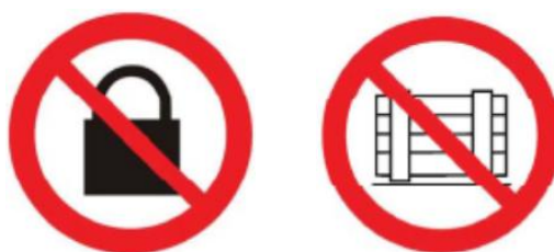
图 B.22 禁止锁闭、禁止堵塞标识图例
